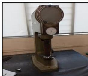
Gambar 3. Alat Uji Kekerasan *Vickers*
