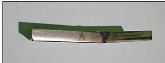
Gambar 5.2 Bentuk *Deformasi* pada Hasil Pengelasan
